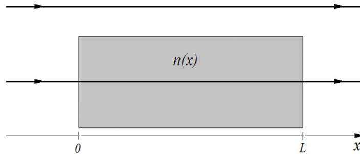
Dois feixes de luz em fase se propagam no vácuo para a direita paralelamente ao eixo  $x$  desenhado na figura. Um dos feixes atravessa um bloco com a forma de um paralelepípedo, em cujo meio o índice de refração é variável, provocando uma diminuição de velocidade e consequente atraso no tempo de viagem.
