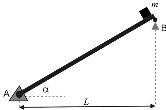
A figura mostra uma rampa inclinada, de massa desprezível, apoiada por dois suportes fixados nos pontos A e B. O apoio em A admite forças horizontais e verticais e o apoio em B apenas forças verticais. Um objeto de dimensões desprezíveis é liberado do ponto B a partir do repouso e se desloca sem atrito em direção a A.
